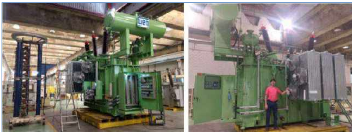
Figura 8 – Transformadores de força durante a recepção em fábrica. Em destaque na figura da direita, está o Eng o Adriano Cabrino, especialista de transformadores da EDP SP.
