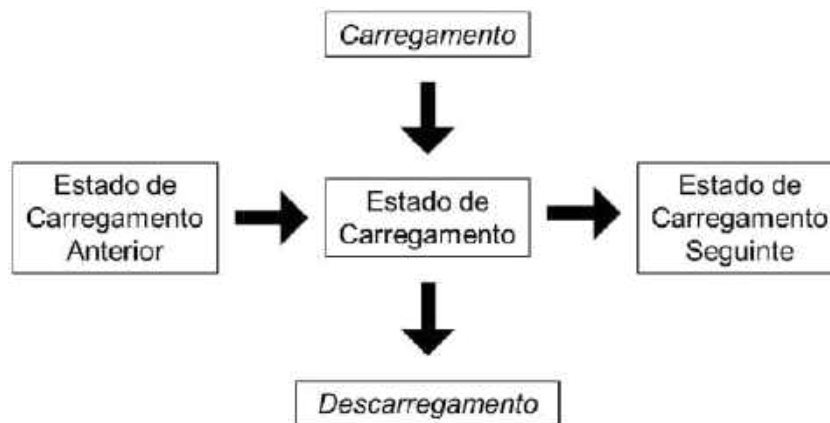
Figura 38: Esquema do funcionamento do SoC no tempo.
