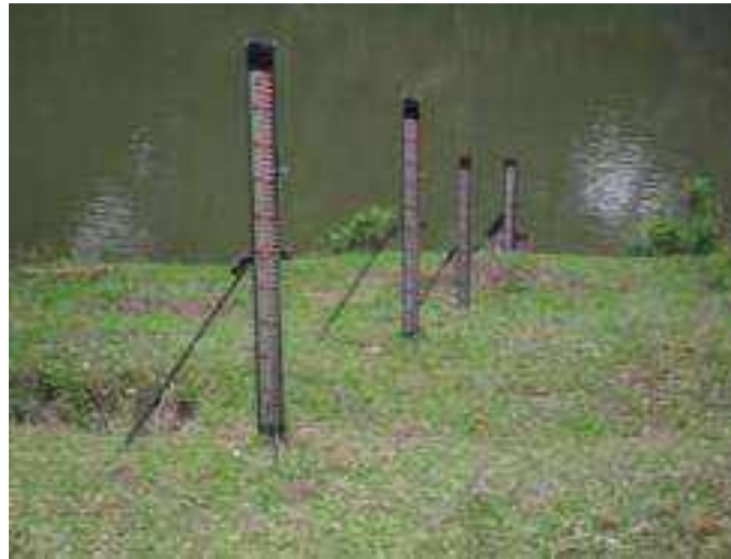
Figura 5 – Exemplo de Estação fluviométrica típica, composta por 5 réguas limnimétricas (ANA, [])
