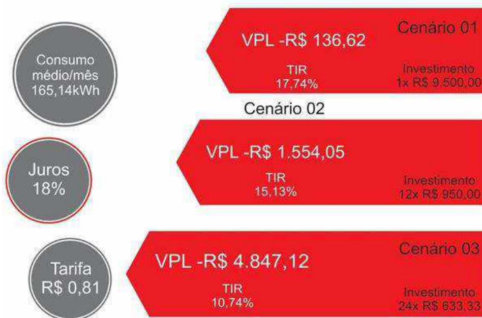
Figura 21 - Valor presente líquido negativo em três cenários de investimentos distintos considerando o consumo médio atual, alternativa de juros mensais máximos e tarifa de energia atual. Fonte: Autor (2018).
