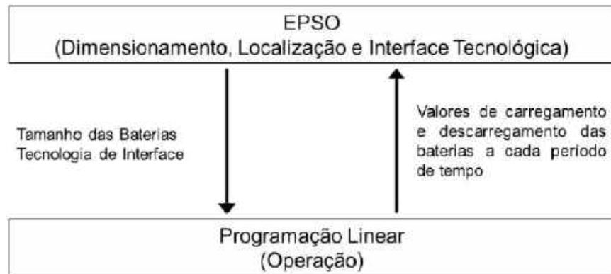
Figura 37: Relação entre os dois métodos de otimização implementados no modelo
